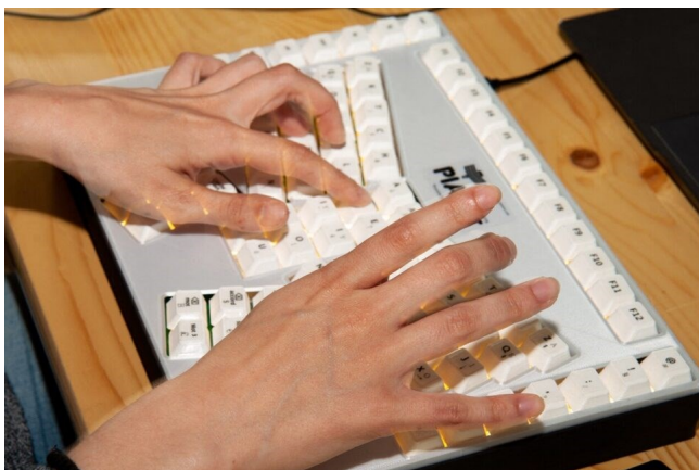
Les lettres de l'alphabet y sont répétées deux fois pour une meilleure ergonomie. ©PIAmot
