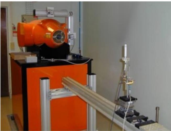
*Conteneur de source ( $^{137}\text{Cs}$ ) utilisé pour l'étalonnage et la vérification de l'étalonnage d'instruments de mesure des rayonnements ionisants selon les méthodes présentées dans les normes NF ISO 4037.*
