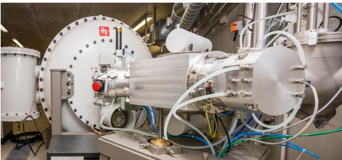
*Accélérateur d'électrons FELIX (Faisceau d'Electrons et Ligne d'Irradiation X) d'ATRON METROLOGY.*
